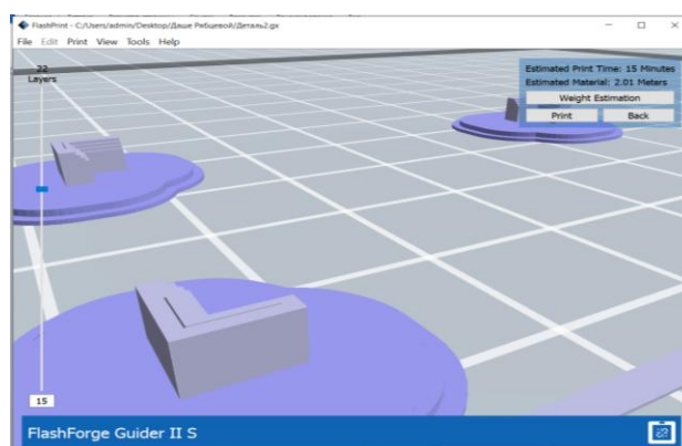
Рисунок 4. Уголки для закрепления образца с ЭИЛ-покрытием на предметном столике 3 принтера
